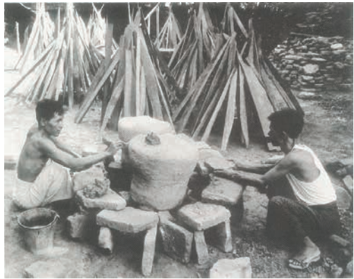
၁၃။ ကြေးသွန်းသူများ ဖားစည်သွန်းလုပ်ရန် ဖိုကြီးပြုလုပ်နေပုံ။
